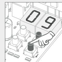
07 • Surge la rampa definida de fábrica. Si pretender, cambie la rampa entre 0 y 9, utilizando ↑ ↓.
