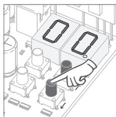
05 • Aparece la función definida de fábrica. Si desea, cambie la función de 00 o 01 utilizando ↑ ↓.
