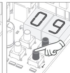
04 • Aparece la función definida de fábrica. Se desea, cambie la función para 01 o 09 , utilizando ↑ ↓.
