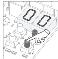
07 • Aparece la función definida de fábrica. Si desea, cambie la función de 00 o 01 utilizando ↑ ↓.
