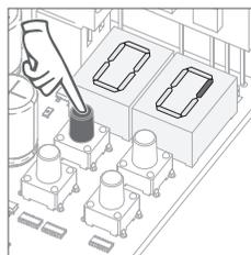
03 • Aparece un movimiento circular en la pantalla indicando que el ajuste automático está en marcha.
