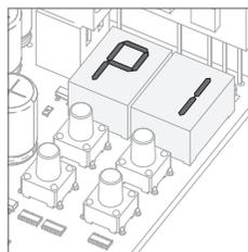
04 • Cuando surge P1, la programación automática terminó. Si desea programar P1 continúe con el paso 03 de menú P1. Para salir de la programación presione ↑ ↓ simultáneamente.
