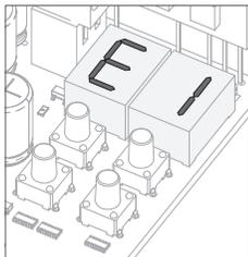
**06** • Aparece E1. Para salir de la programación presione ↑ ↓ simultáneamente.
