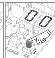
05 • Aparece la función de fábrica. Si lo desea, cambie la función a 00 o 01 utilizando ↑ ↓.
