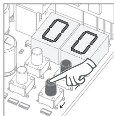
04 • Aparece la función definida de fábrica. Si desea, cambie la función para 00 o 01, utilizando ↑ ↓.
