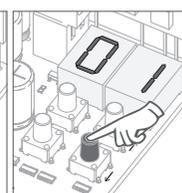
08 • Aparece la función de fábrica. Si lo desea, cambie la función a 00 o 01 utilizando ↑ ↓.
