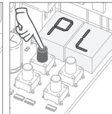
09 • Aparece E1. Para programar E1 continúe con el paso 3 del menú E1 (p.11B). Para salir de la programación presione ↑ ↓ simultáneamente.
