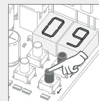
05 • Surge la rampa definida de fábrica. Si pretender, cambie la rampa entre 0 y 9, utilizando ↑ ↓.
